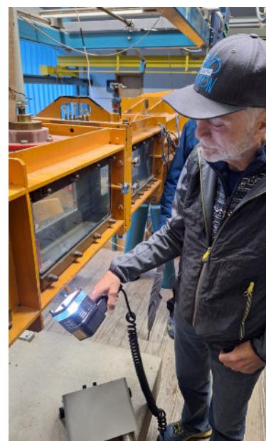
Kavitations-Prüfstand mit K.-H. Richter und Stroboskop
